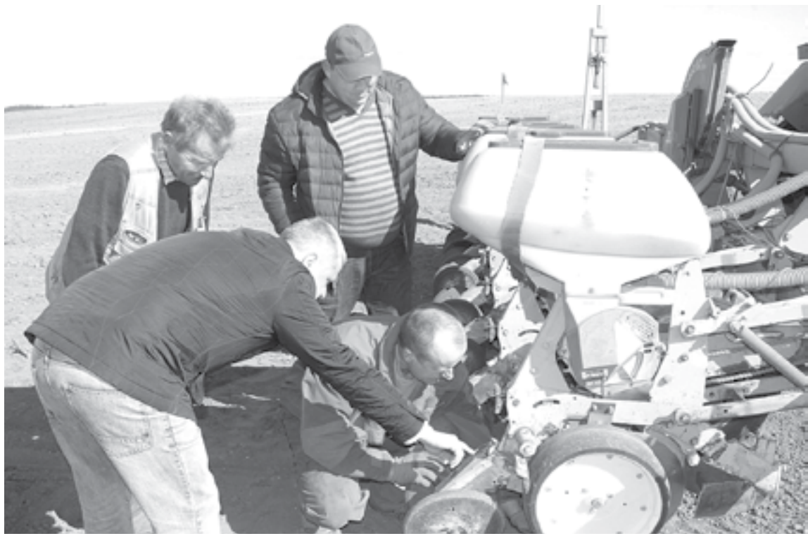
Главный агроном Виктор МИНЬКО, заведующий производственным участком Иван РОГАЦЕВИЧ, представитель фирмы «КВС» Виктор ВЕРТЕЙКО вместе с механизатором Виктором БУЙКО регулируют сеялку на необходимую глубину заделки в почву семян кукурузы. Фото автора
